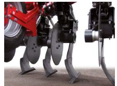
Рабочие органы можно дополнительно оснастить дисковыми ножами.
