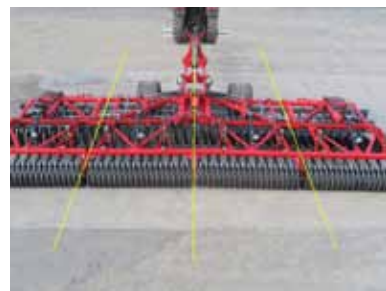
Čtyřdílný pracovní rám pro dokonalé kopírování terénu. Vierteiliger Arbeitsrahmen für perfektes Gelände kopieren.
