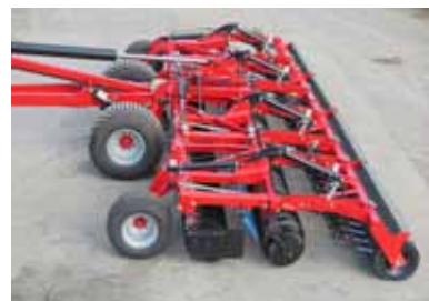
Plně hydraulicky ovládané nastavení pracovní hloubky. Vollhydraulisch gesteuerte Arbeitstiefenverstellung.
