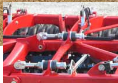
Systém odpružení a zámku křídel WingLock. WingLock Federsystem und Flügelschlos.
