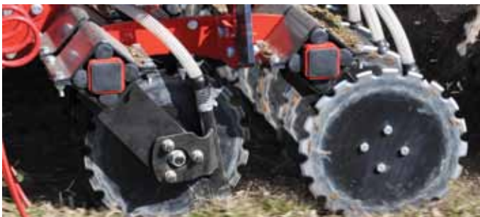
Drill coulters (410 x 5 mm) mounted on the solid rubber silentblocks. Disques ouvreurs montés à l'aide de silentblochs en caoutchouc. Dimensions du disque - 410 mm x 5 mm.
