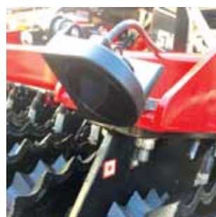
Automatic dose regulation by the sensors. Réglage automatique de la dose en fonction de la vitesse à l'aide de capteurs.
