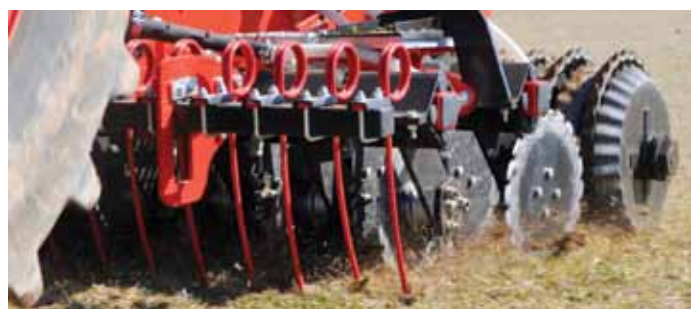
Wire brushes remove old grass from the lawn and help with seedbed preparation. Herse peigne pour la préparation du lit de semences. Elle retire les vieilles herbes et prépare le sillon pour chaque disque ouvreur.
